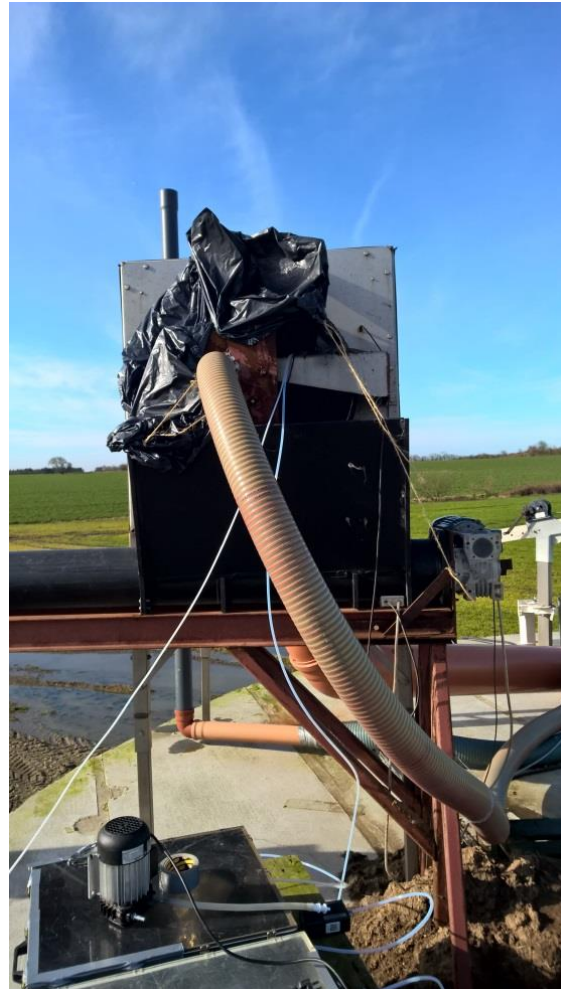
Figur 6. Lugtprøveudtagning af lugt og svovlbrinte fra procestank og Smellfighter i besætning B. a) Åbningen til procestanken blev tildækket, således at luften løb gennem det overskårne rør, hvor teflonslangerne var isat. b) Afdækning af åbningen til tromlesien og teflonslangerne er ført ca. 15 cm ind i åbningen.
